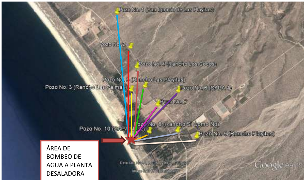
Figura 9.- Ubicación de cada uno de los pozos muestreados y su distancia en línea recta al sitio de bombeo del proyecto de planta desaladora.
